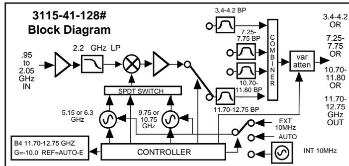
**FIGURE 1.2 3115-41-128# Block Diagram**
